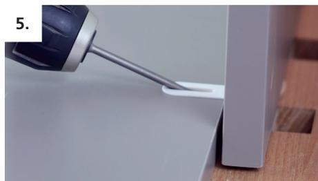
5. Die Blindfront mit dem Korpus verschrauben. Einfaches und schnelles Verschrauben mit voreingestelltem Drehmoment von ca. 2.5 Nm
