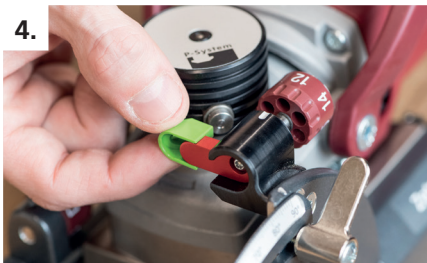
P- System Tiefenstelleraufsatz 4 mm aufstecken (effektive Frästiefe 8 mm)
