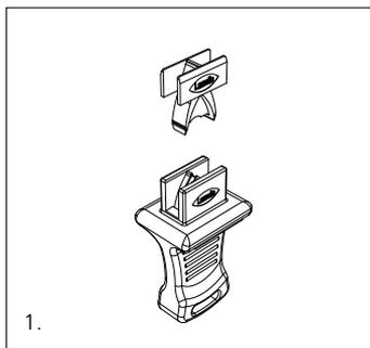
1. Vorspann-Clip auf Eindrückwerkzeug setzen
