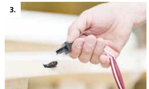
3. Vorspann-Clip auf Eindrückwerkzeug setzen
