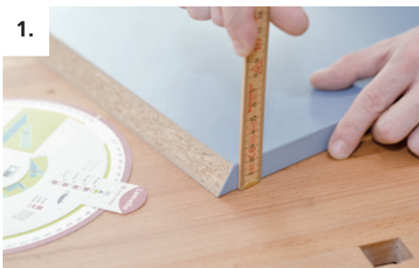
Werkstück Dicke ermitteln und Verbindungselement bestimmen
