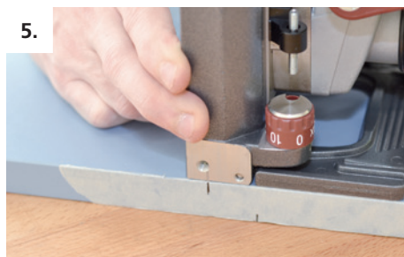
Zeta P2 auf Markierung ausrichten und Nut fräsen
