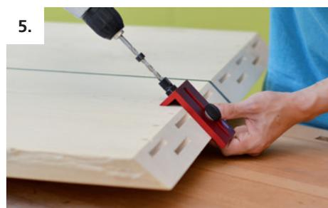
Zugangslöcher bohren (je nach Materialstärke die längere Bohrlehre verwenden)
