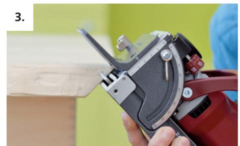
Fräsposition mit der Maschine überprüfen um ein Durchfräsen zu verhindern
