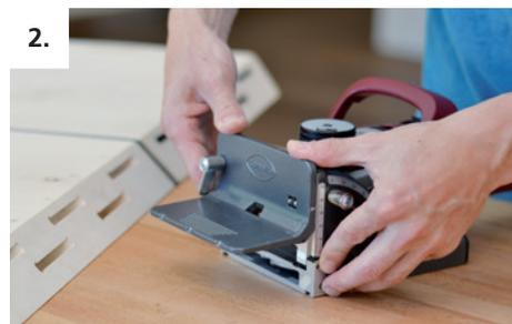
Für die versetzte Nut: Anschlagewinkel aufschieben und Position einstellen
