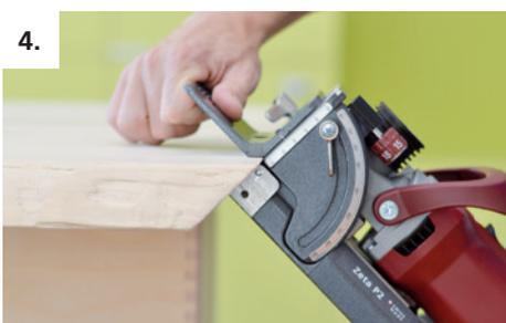
Die Zeta P2 mit dem Anschlagwinkel an der Aussenfläche anlegen und versetzte Nuten fräsen
