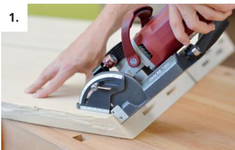
Verbinderposition anreissen und Profilmutter mit der Zeta P2 fräsen (Anschlag auf der Innenseite)
