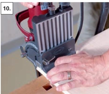
10. In die Fläche fräsen mit zweitem Anschlagswinkel
