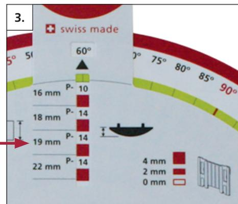
3. Bei der verwendeten Materialstärke **19 mm** Verbinder-Grösse **P-14** sowie Aufsteckplattenstärke **4 mm** ablesen
