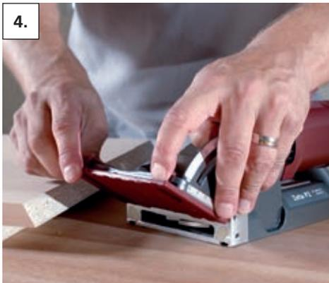
4. Schwenkanschlag auf **60°** stellen und **4 mm** Aufsteckplatte montieren
