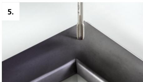
Metrisches M6 ISO-Gewinde nach DIN 13-1 in die Bohrung schneiden
