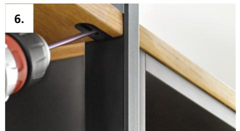
Werkstücke mit einem Metallrahmen verbinden
