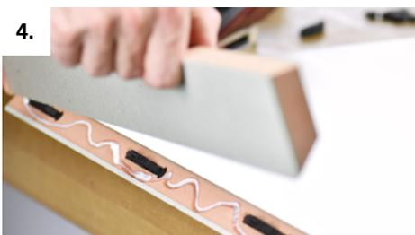
4. Werkstücke zusammenfügen und warten bis der Klebstoff ausgehärtet ist.
