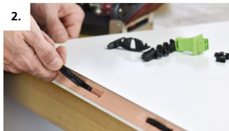
2. Tenso-P-10 Verbinderhälfte in die Werkstücke einschieben.
