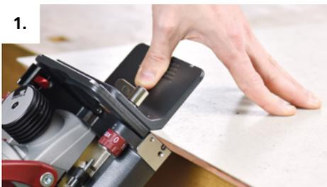
1. P-System Nuten mit der Tiefeneinstellung 10 in die Schnittflächen fräsen.
