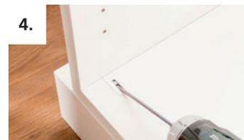
4. Möbelemente mit Akkuschauber und Cabineo-Werkzeug verbinden. Einfaches, schnelles Arbeiten mit voreingestelltem Drehmoment ca. 2.5 Nm
