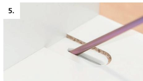
5. Werkstücke mit Akkuschauber verbinden (Drehmoment ca. 2.5 Nm)
