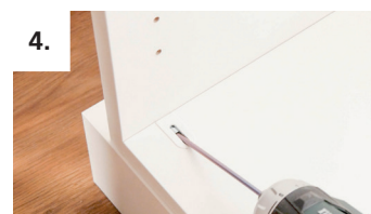
4. Möbelemente mit Akkuschrauber und Cabineo-Werkzeug verbinden. Einfaches, schnelles Arbeiten mit voreingestelltem Drehmoment ca. 2.5 Nm
