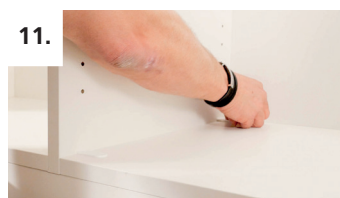
11. Falls gewünscht Abdeckkappen auf den Cabineo aufstecken
