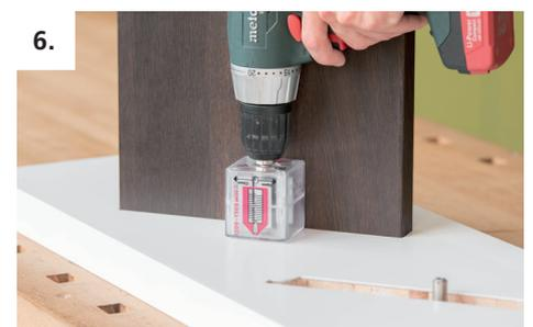
6. Tritt mit der Wange zusammenfügen und mit dem Minimag festziehen
