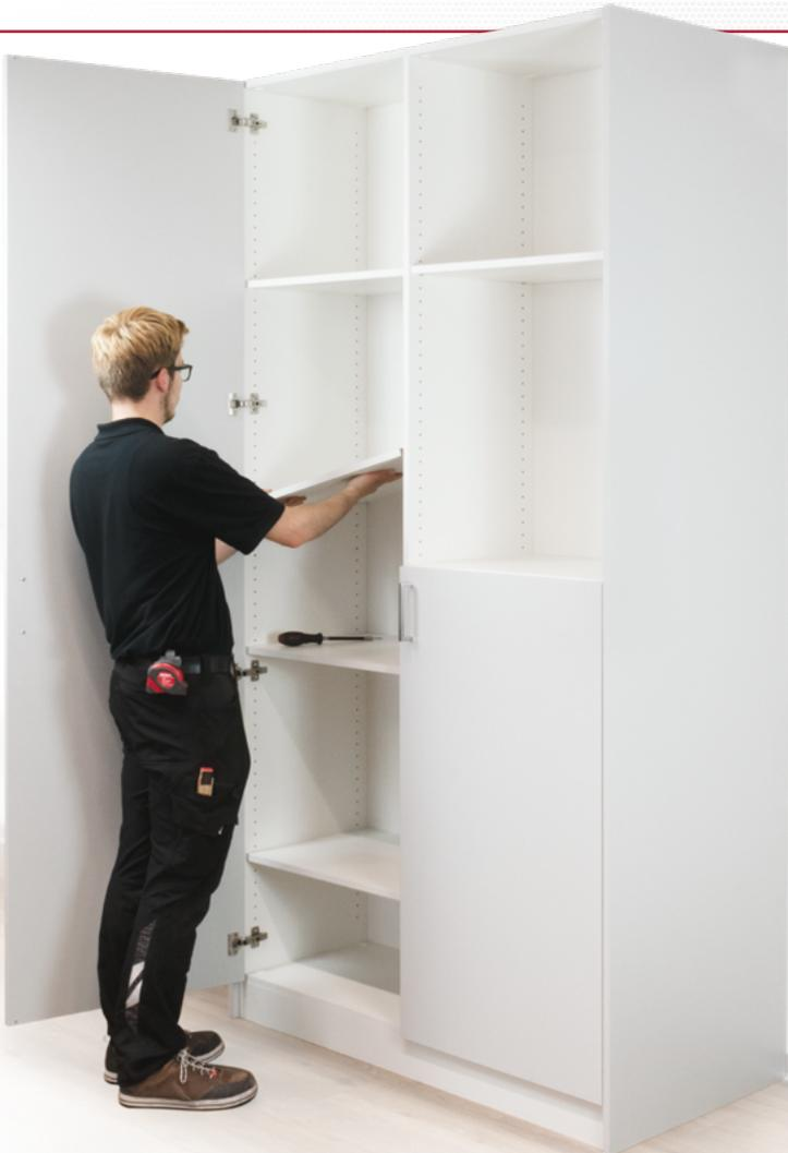
Sie sind beim Kunden und möchten einen fixen Fachboden oder eine Mittelseite in einen bereits montieren Schrank einbauen? Dank dem Clamex P-14 Flexus können Sie dies schnell und einfach umsetzen.
