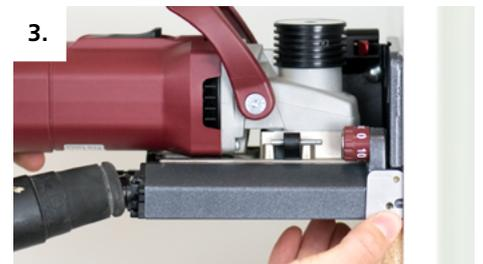
3. Zeta P2 an der Markierung ausrichten und Nuten in Schrankseiten fräsen
