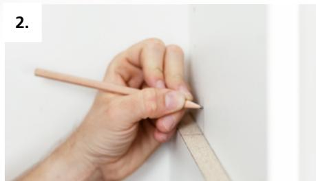
2. Fräsachse vom Fachboden an der gewünschten Position auf den Schrankseiten anreissen
