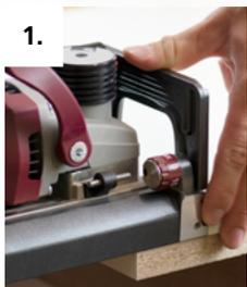
1. P-System Nuten in die Fachböden fräsen und Mittenposition auf Werkstück übertragen. Zugangsöffnung bohren
