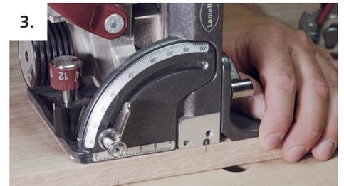
3. Zeta P2 an der Mittenmarkierung ausrichten und Nuten in die Fläche fräsen.
