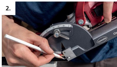
2. Position der Mittelmarkierung auf das erste Werkstück übertragen.
