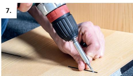
7. Verbinderhälften mit Schrauben befestigen. Bei spröden Materialien 2 mm Löcher vorbohren.
