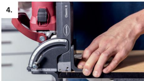
4. Maschine ausrichten und den Anschlagwinkel für eine exakte Fräsung an der Stirnkante anschlagen.
