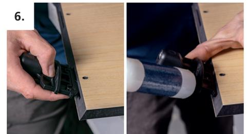
6. Verbinder auf die Bohr- und Ausrichtlehre aufstecken, in die Nut einschieben und mit leichten Hammerschlägen ausrichten.
