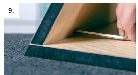
9. Clamex S-20 festziehen. Bauteile lassen sich nun beliebig oft zusammensetzen und wieder zerlegen.
