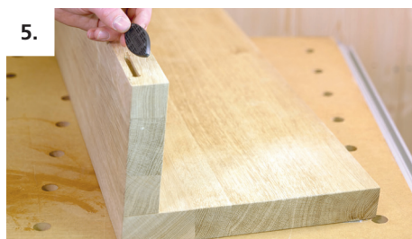
5. Zum Überprüfen Verbindung mit Bisco P-14 trocken zusammenstecken.
