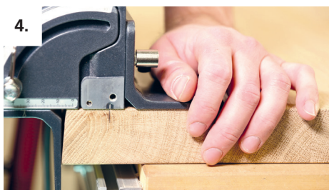
4. Zeta P2 auf Markierung ausrichten und Nut fräsen.
