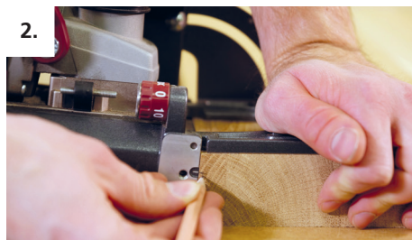
2. Mitte der Fräsung auf das Werkstück übertragen.
