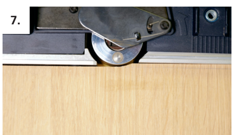
7. Bauteile mit der Hobelmaschine anpassen.
