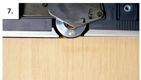
7. Adapter les éléments à la configuration de la pièce à l'aide d'une raboteuse.
