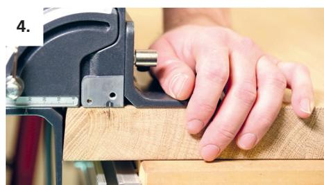
4. Positionner la Zeta P2 sur le repère et fraiser la rainure.
