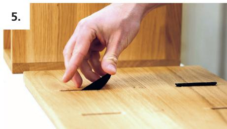
5. Tenso P-14 Verbinderhälften in die P-10 Nuten einschieben.
