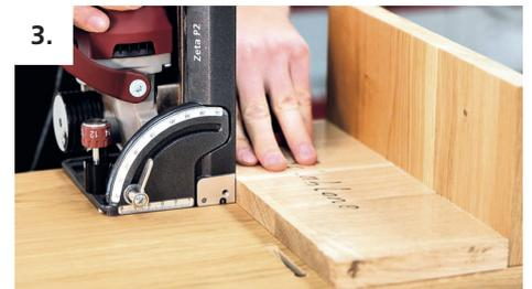
3. Die Fräsungen in die Fläche beidseitig mit der Tiefeneinstellung 10 ausführen.
