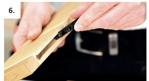
6. Tenso P-14 Verbinderhälften in die P-18 Nut einschieben.
