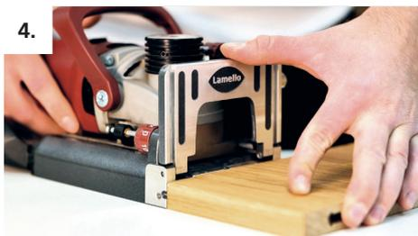
4. P-System Nutfräsung in die Stirnseite mit der Tiefeneinstellung 18.
