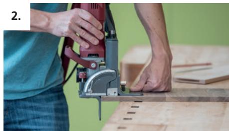
Profilnutfräsung in das Vorderstück mit der Tiefeneinstellung 10
