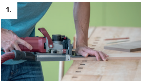
Profilnutfräsung in die Seite mit der Tiefeneinstellung 18
