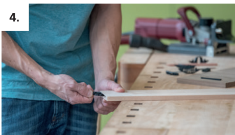
Halbschale mit Feder in die Schubladenseiten einschieben
