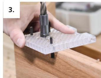
3. Übertragen der Bohrungen mit Hilfe der Rasto Bohrlehre auf das Tablar
