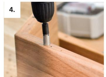
4. Invis Mx2- Verbinder bündig in das Tablar eindrehen
