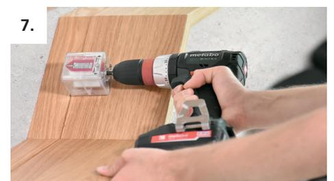
7. Bauteile mit dem Minimag und einer Drehzahl von 1200–1500 min<sup>-1</sup> befestigen
