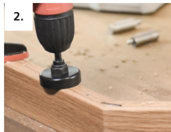
2. Mit der Eindrehlehre die Eindrehmutter befestigen
