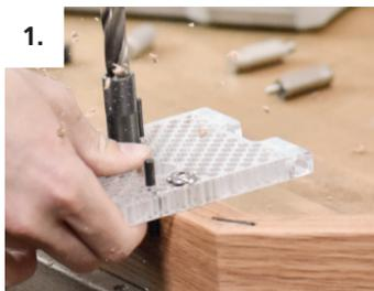
1. Dank Rasto Bohrlehre präzise in die Montageleiste bohren
