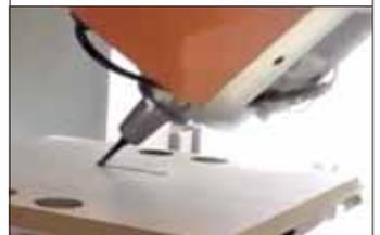
P-System Schaftwerkzeug in Hauptspindel (5-achs)
