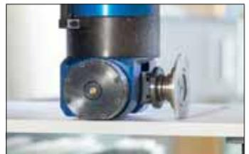
P-Systemfräser mit FLEX5C (max. 10 mm)
