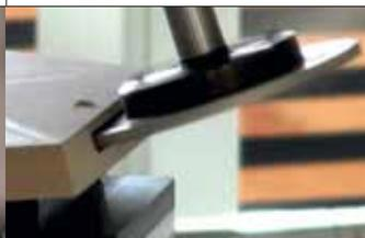
P-Systemfräser in Hauptspindel (5-achs)
